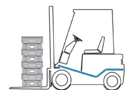
Aufnahmesystem mit Gabelstapler
